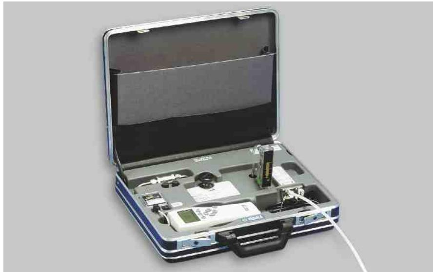
Le DSS70A est une solution compacte pour la mesure sur site du point de rosée lorsqu'il est difficile d'effectuer une mesure directe. Des applications typiques du système d'échantillonnage sont par exemple les process de traitement des métaux et de séchage des plastiques.
